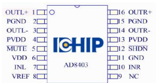
图 2. AD8403 SOP-16 封装引脚分布图
